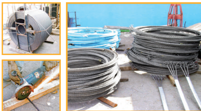
Imagem 12: Fabricação de cabos. Nos detalhes, equipamentos para o corte de cordoalhas.
