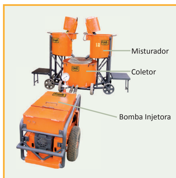
Imagem 41: O equipamento Rudloff para injeção
