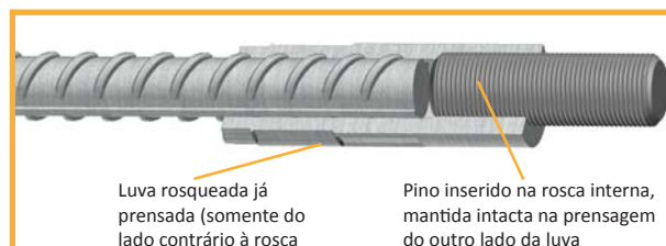
Figura 15: Vista da luva em corte, mostrando a prensagem e o pino rosqueado
