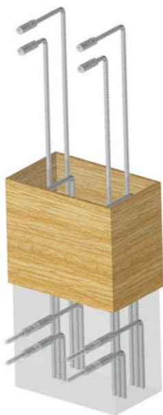
Figura 18: Uso de luvas em fôrmas deslizantes
