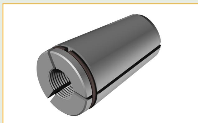
Cunha para protensão de estruturas, usinada em tornos CNC, rosqueadas, tripartidas, que depois sofrem tratamento térmico.
