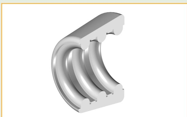
Componente para arraste de válvulas de motores de combustão interna. Usinado em aço baixo carbono em tornos automáticos, com operação de corte e processo de tratamento térmico posterior.
