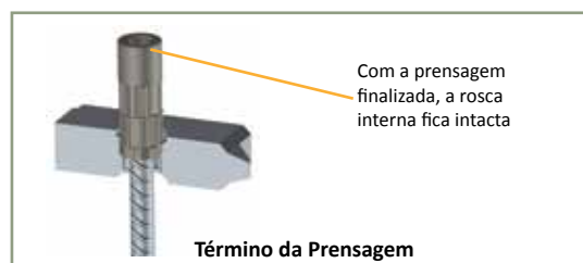
Figura 14: Operação de prensagem de luva com rosca
