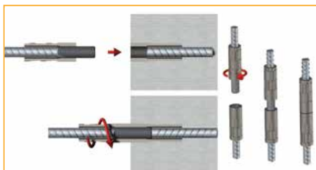
Figura 16: Montagem da emenda direita-direita
