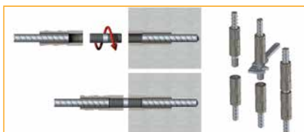
Figura 17: Montagem da emenda direita-esquerda
