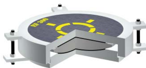
Imagem 08: Seção transversal do aparelho tipo EF
