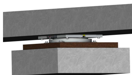
Fig. 43 - Remoção da fixação
